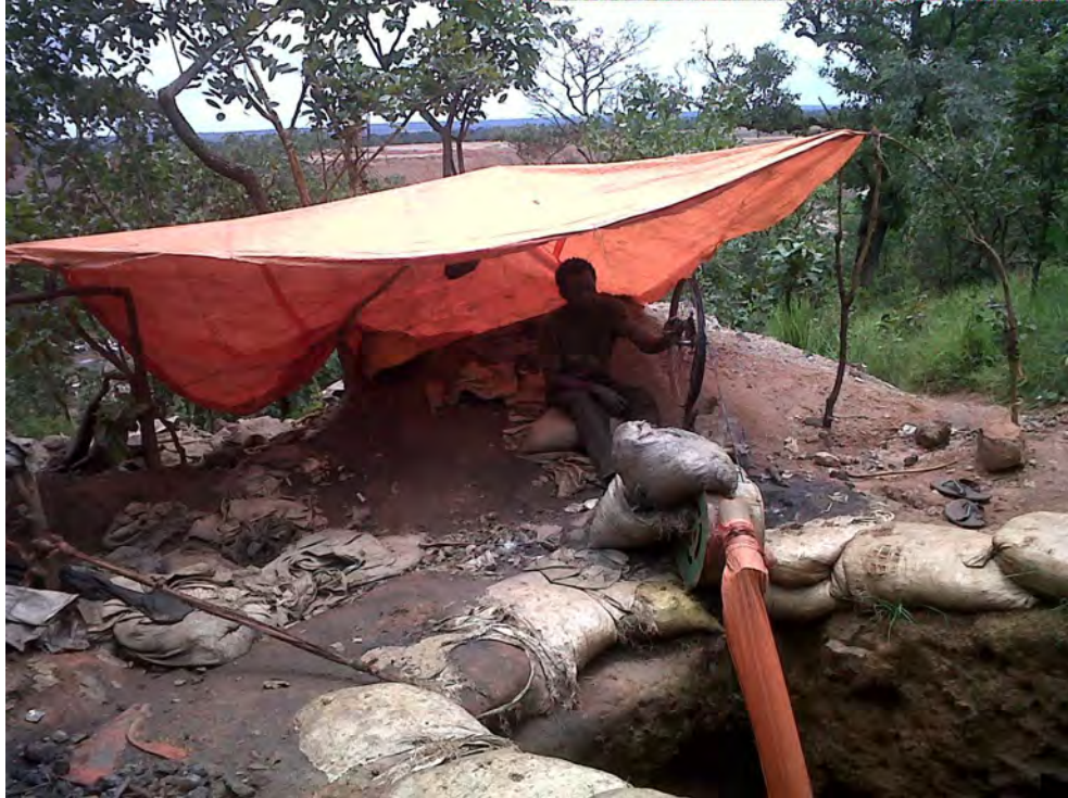
Improvised ventilation for a mine shaft at the Tilwezembe mine site, near Kolwezi, February 2012 © Action Contre l'Impunité pour les Droits Humains (ACIDH)
